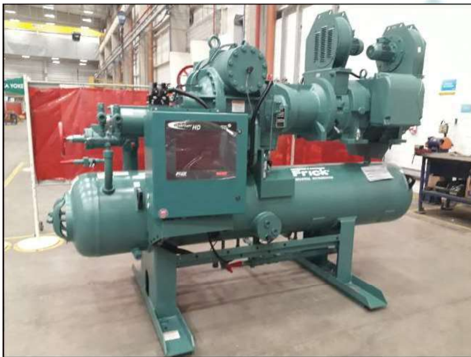
Figura 2 - Unidade Compressora Parafuso RWF II com Controlador Quantum HD
