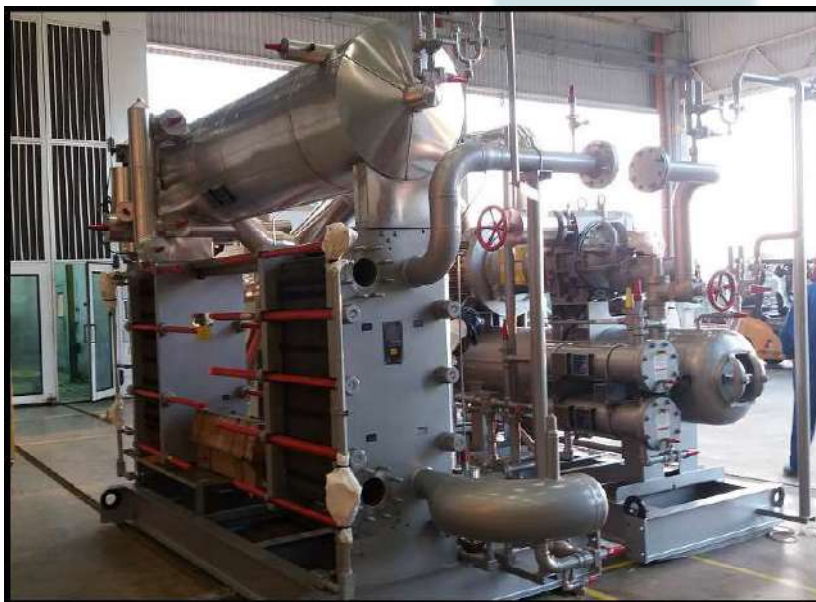
Figura 3 - Unidade Compressora Parafuso RWF II com controlador Unisab III ou Quantum HD
