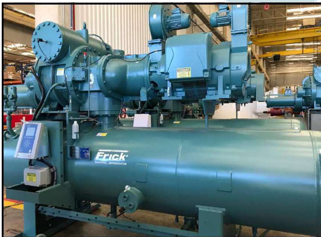
Figura 1 - Unidade Compressora tipo Parafuso RWF II com Controlador Unisab III
